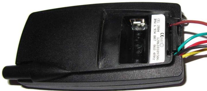
Abbildung 6: Geschlossener Handsender nach Anschluss aller Leitungen.
