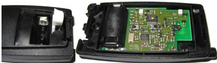
Abbildung 4: Öffnen des Handsenders – die Schraube unter dem weißen Aufkleber wird herausgenommen und die Platine frei gelegt.
