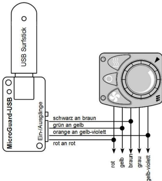
Abbildung 2: Anschluss des MicroGuard-USB Moduls an die Leitungen am Mini-Regler von Eberspächer. Verbindung zwischen grün und gelb nur notwendig, wenn die aktive Rückmeldung zum Schaltvorgang genutzt wird (siehe Beschreibung).
