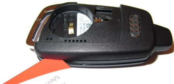
Abbildung 3: Öffnen des Handsenders mit Hilfe einer alten Kreditkarte
