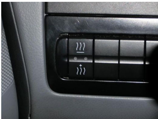
Abbildung 2: Standheizungsschalter im Volkswagen Crafter
