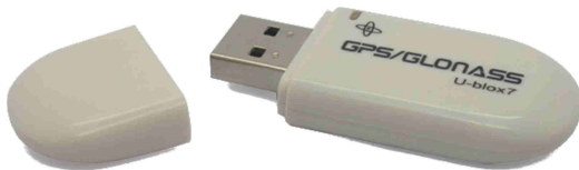
Ilustracja 4: Przykład odbiornika GPS kompatybilnego z naszym modulem. Lista kompatybilnych odbiorników znajduje się na naszej stronie internetowej.
