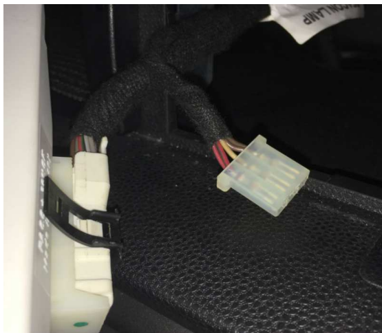
Abbildung 2: Schnittstelle zum Funkempfänger an Westfalia Zentralelektronik im Ford Nugget.
