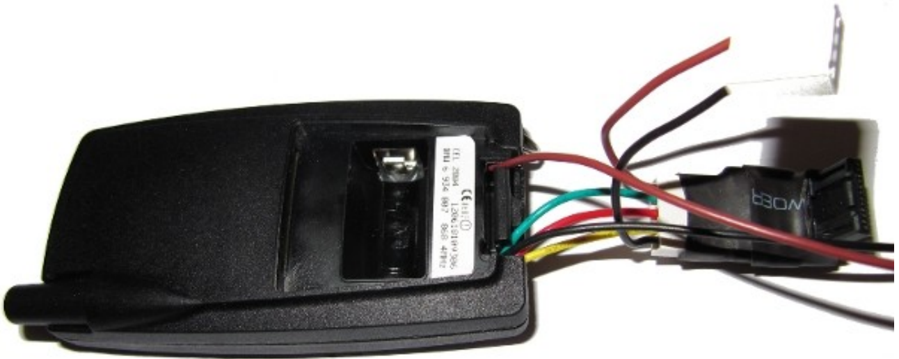
Abbildung 5: Funk-Fernbedienung nach Anschluss der Kabel und nach Zusammenbau
