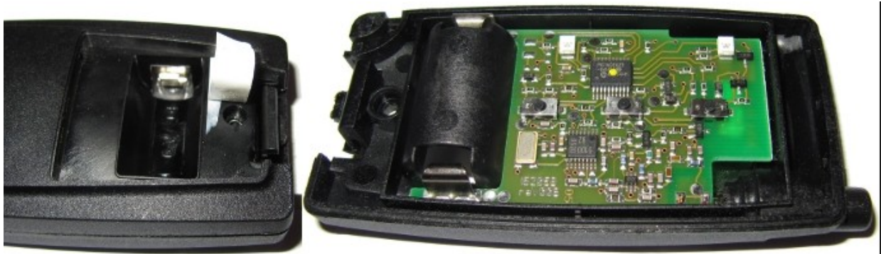
Abbildung 1: Zum Öffnen der FB entfernen Sie die Batterie und schrauben die Schraube unterhalb des Aufklebers heraus.
