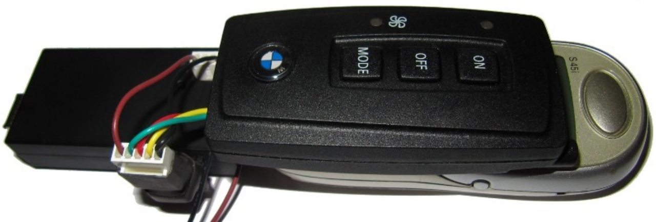
Abbildung 6: Funkfernbedienung am Modul und Hand
