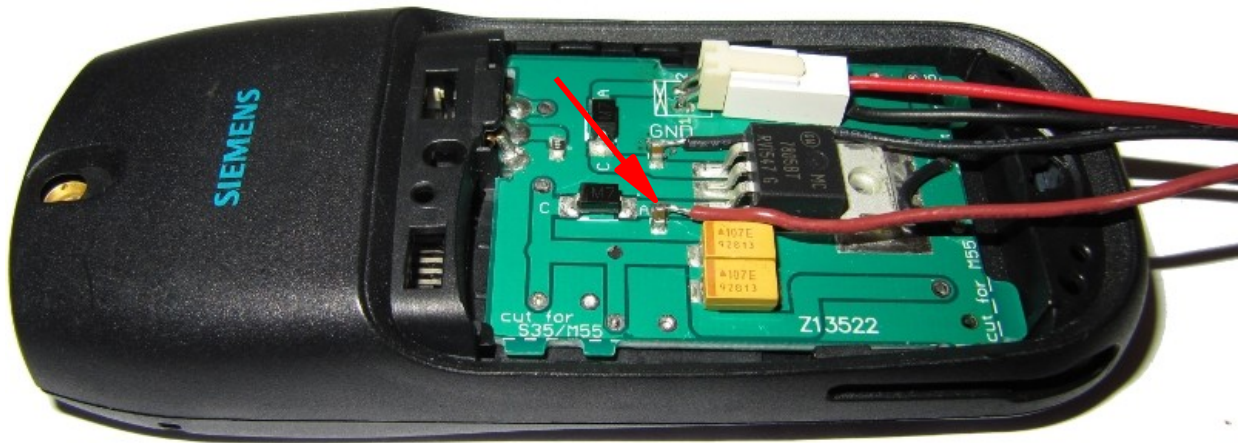
Abbildung 3: Anschluss der Versorgungsleitungen an den Akku-Ersatz
