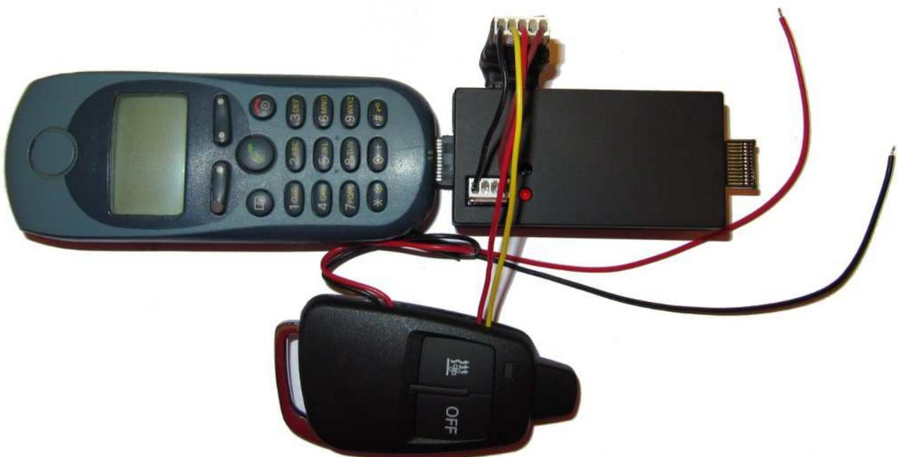
Abbildung 6: Komplettes System mit Handy, Modul und Handsender. Nur die Leitungen für +12V und Masse verbleiben zum Anschluss an das Fahrzeug
