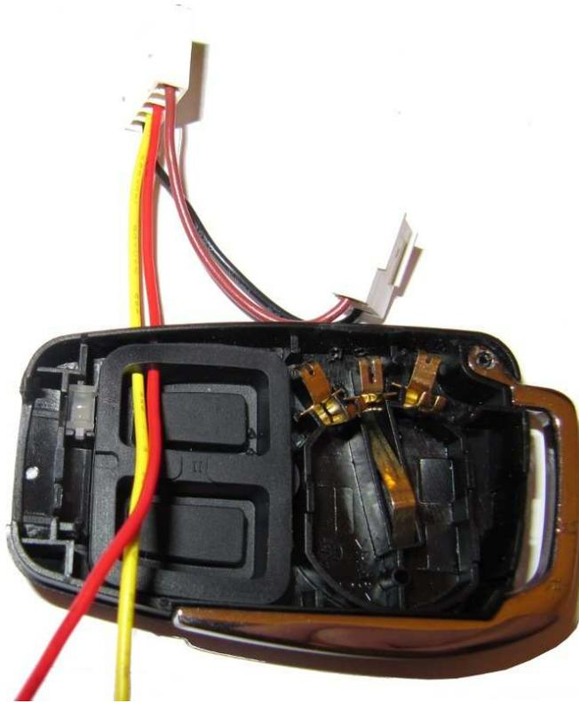
Abbildung 3: Führung der Steuerleitungen nach Außen durch den Gummitaster
