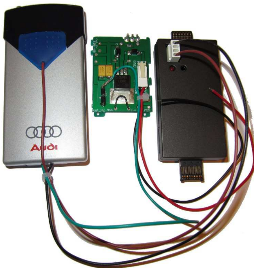
Abbildung 4: Fertiges System - bereit zum Anschluss an +12V und Masse des Fahrzeugs.
