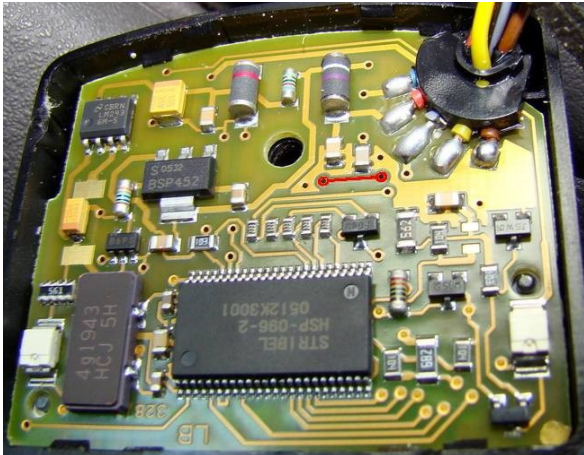
Abbildung 4: Anschlusspunkt (rote Leiterbahn) für die Steuerleitung von MicroGuard-USB an die Rückseite der Platine nach Abnehmen der Rückwand
