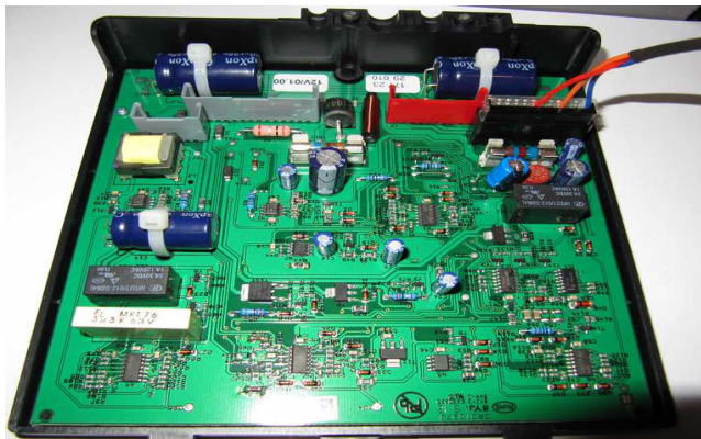
Abbildung 4: Steuerplatine der Truma e2400 und e4000, Zubehörschnittstelle
